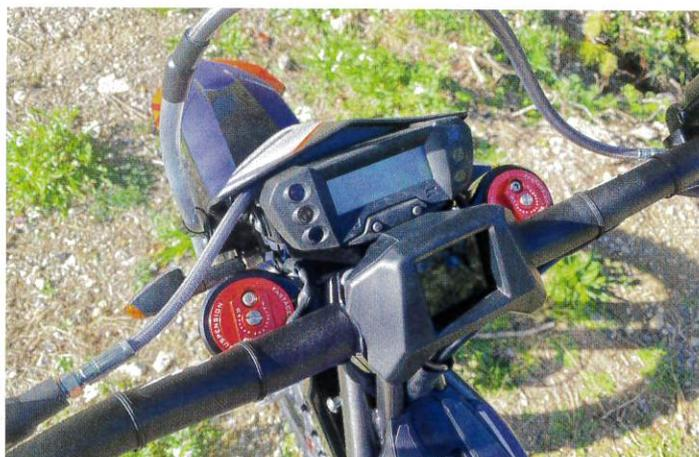
**Les Escape possèdent trois maps sélectionnables au guidon, un traction control et l'application EM Connect. Réglages via son smartphone.**
