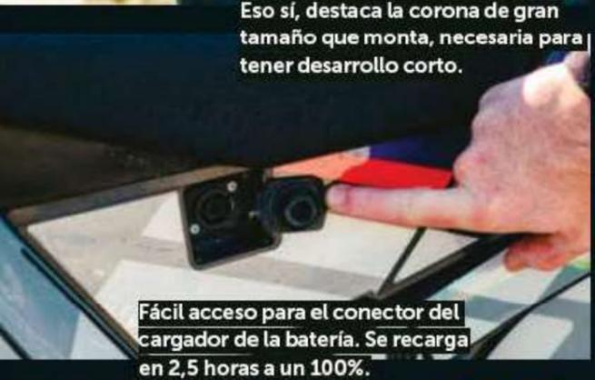
**Fácil acceso para el conector del cargador de la batería. Se recarga en 2,5 horas a un 100%.**
