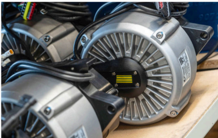
Les moteurs proviennent de Grande-Bretagne, avec des spécificités EM (arbre primaire). Ils développent 6 kW avec des pics à 11-12 kW.
