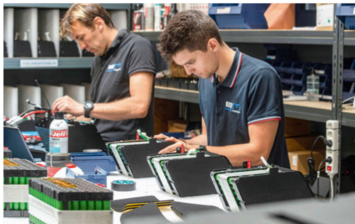
Sur la base de cellules li-ion provenant du Japon, Electric Motion assemble ses propres batteries, un des secrets de son savoir (bien)-faire.
