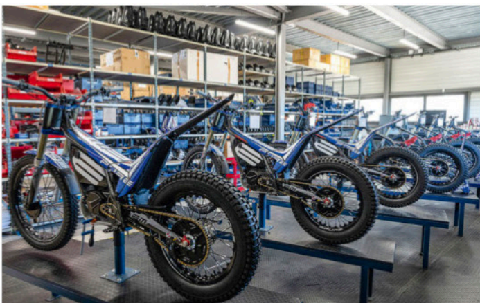
Châssis et suspensions équivalent à une thermique. Le cadre en acier au chrome molybdène est conçu autour de pièces réalisées en micro-fusion.
