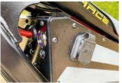
La mise sous tension du système s'effectue en appuyant sur ce bouton, la lumière bleue en témoigne. Sur le côté de la batterie, la cosse pour la recharge.
