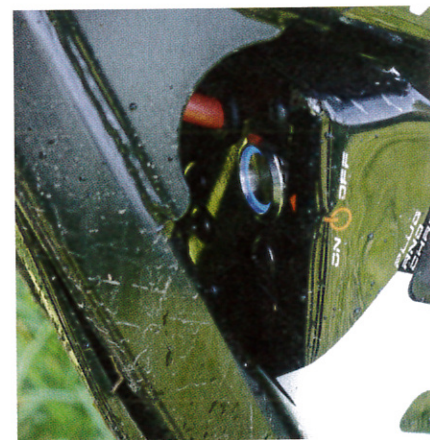
Solide geschmackvolle Details hinter jedem Eck: LED hinterleuchteter Magnethauptschalter, der den Kraftschluss herstellt. Gut geschützt vor Sturz oder Verschmutzung.
