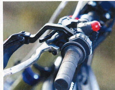
Le commodo près de la poignée permet de sélectionner les courbes de puissance. Protège-mains en option.
